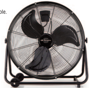
Ref. A060561 33933 EDM 180 W. 3 aspas Ø 60 cm. Altura 70 cm. 3 velocidades. Caudal de aire 7.500 m³/h. 59,8 dB. Con ruedas. 83,20€
