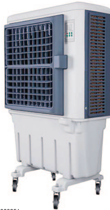
Ref. A069251 722319008 METALWORKS 310 W. Tanque 60 L. Consumo de agua 4-6 l/h. Caudal de aire 8.000 m 3 /h. Silencioso. 63 dB. Para espacios abiertos o semiabiertos. Dispositivo UV antibacteriano para la esterilización del agua (lámpara UV colocada en el tanque). Con ruedas. 50-70 m 2 . 86x49x140 cm.
